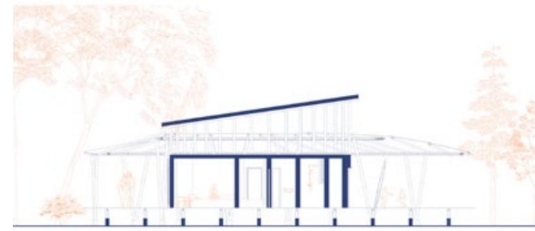
UNE TRIPLE TOITURE POUR LA CIRCULATION DE L'AIR
